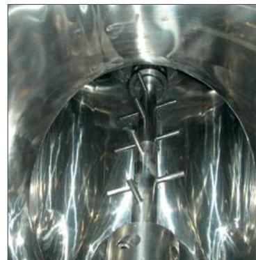
Barra intensificadora para deshacer grumos, con sistema de retenes de fricción para repeler el polvo. Motor eléctrico para el accionamiento de esta.
